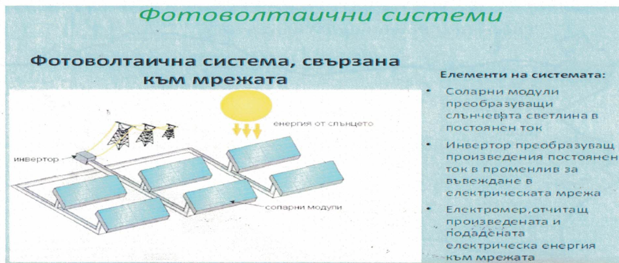
Фиг. 10 Фотоволтаична система свързана към мрежата
